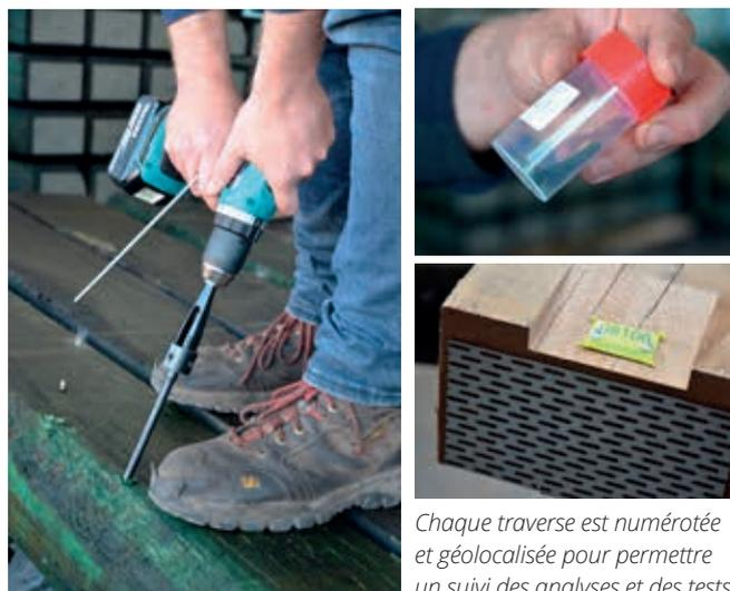
*Chaque traverse est numérotée et géolocalisée pour permettre un suivi des analyses et des tests.*
