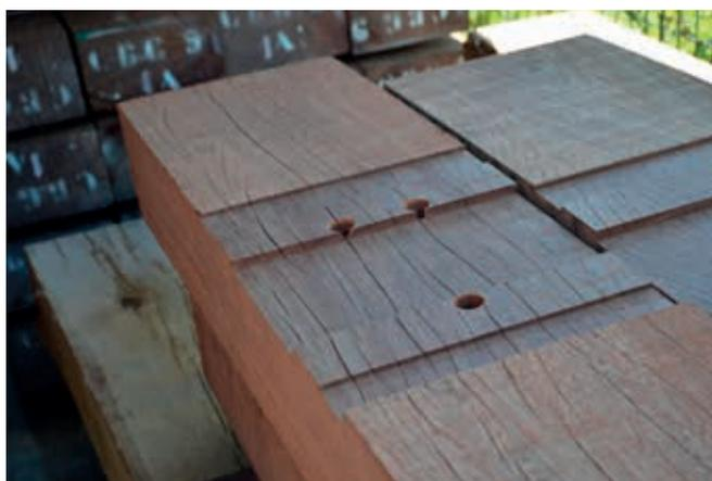
*L'entaillage des traverses est une opération de haute précision. Chaque réseau ferroviaire possède ses propres standards. A titre d'exemple, plus de 100 types d'entaillages cohabitent sur le réseau français !*
